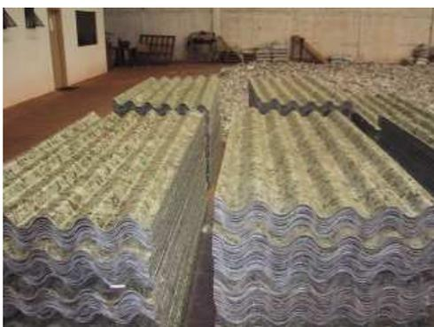
*2 - Pela prensagem do plástico e alumínio: o composto de plástico/alumínio é picado e prensado a quente, formando chapas semelhantes à madeira, ideais para a produção de móveis e divisórias. Essas chapas podem ser transformadas também em telhas (figura ao lado) utilizadas na construção civil.*
