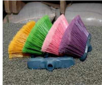
O alumínio presente no composto não atrapalha o processo final de fabricação de peças por termo-injeção, rotomoldagem ou sopro. Os produtos finais são vassouras e coletores.
