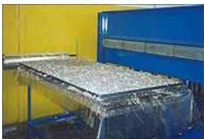
*Fabricação de telhas recicladas com plástico e alumínio*
