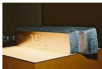
*Lingote de alumínio obtido com processo de reciclagem a plasma*
