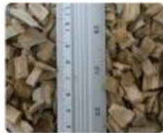
Cavaco fino até 3mm, Cavaco pequeno 8mm, Cavaco médio 16mm
