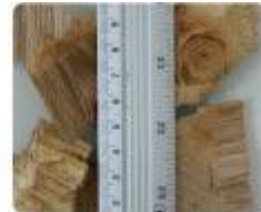
Cavaco Comum 25mm, Cavaco Grande 45mm, Cavaco Extra grande 63mm
