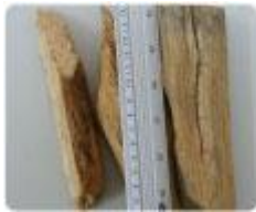
Cavaco fino até 3mm, Cavaco médio 16mm
