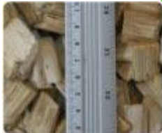
Cavaco Comum 25mm, Cavaco Grande 45mm, Cavaco Extra grande 63mm
