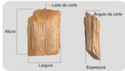
Cavaco fino até 3mm, Cavaco médio 16mm
