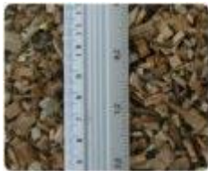
Cavaco fino até 3mm, Cavaco pequeno 8mm, Cavaco médio 16mm
